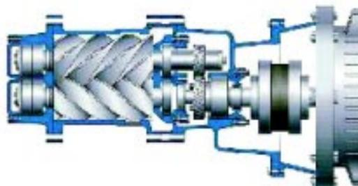
Equipados com motores elétricos do tipo assíncrono, trifásico, de alta eficiência, diretamente conectados à unidade compressora.
